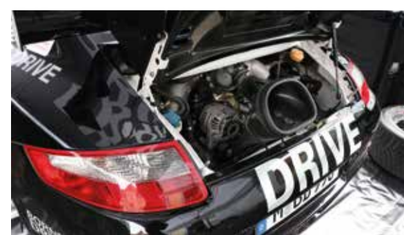
Im Kofferraum verbaut befindet sich das Herzstück des Porsches 997 GT3, der sechsylinder Boxermotor.
